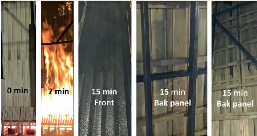
Figur 3c. Godt montert solid trepanel: Ingen gjennombrenning, brann slokket etter 15 minutt.
