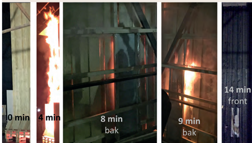
Figur 3b Gjennombrenning i fagmessig montert trepanel etter 8 minutt. Vanlig tre-lag vindu røk ikke.
