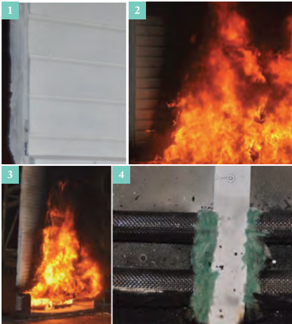
Figur 12 (venstre). Fullskalatest med liggende, luftet panel og med ventilert brannstopp ved bunnsvill. Bilde 1 er tatt før branntest SP 105, mens de neste to bildene (2–3) er tatt fra den cirka 15 minutt varige brannpåkjenningen (opp mot 5 MW). Det siste bildet (4) er tatt etter brannen var over, der panelet er fjernet. En kan se at det knapt er sot på vindsperre over ventilert brannstopp. Brannstopp var montert ved luftinntak nederst i kledningen, som er vanligst.
