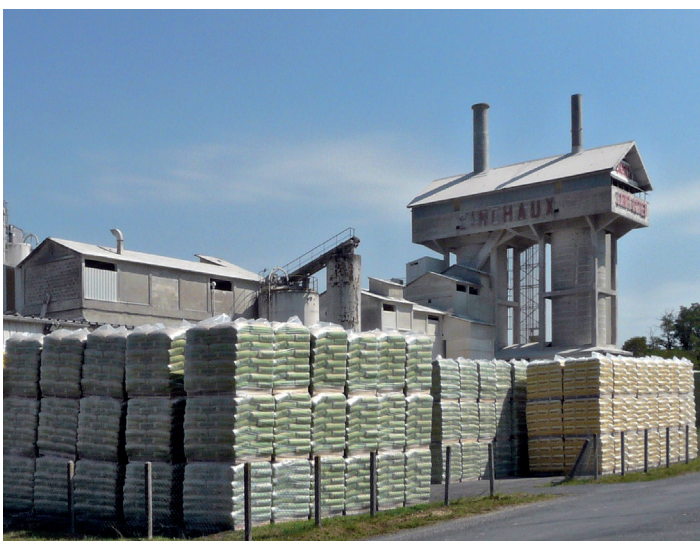
▲ Det meste av kalken som brukes til restaurering i Norge i dag er langreist og kommer fra store industrioivner, som her i St. Astier (Frankrike), der det produseres mange tusen tonn hydraulisk kalk (NHL) om dagen. Foto: Père Igor, Wikimedia Commons
