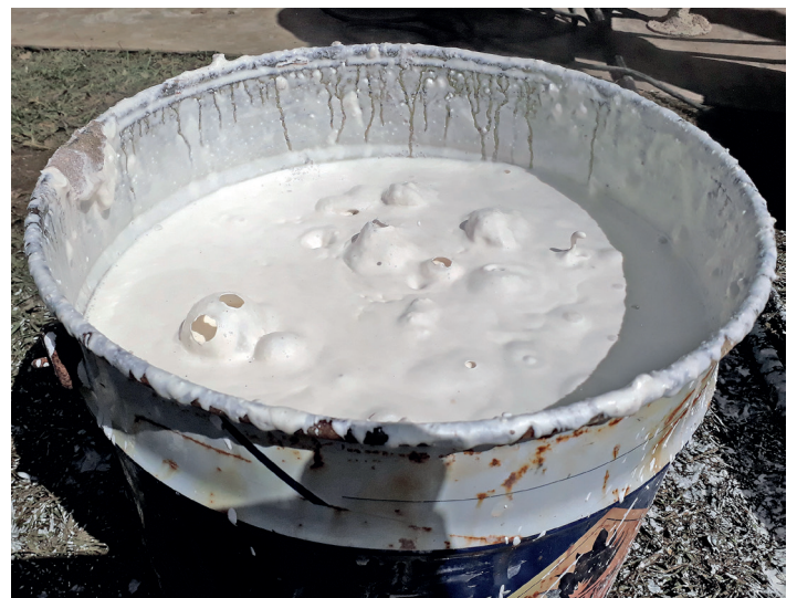
▲ «Koklesking» (våtlesking) av vedbrent kalk til slemming og hvetting
